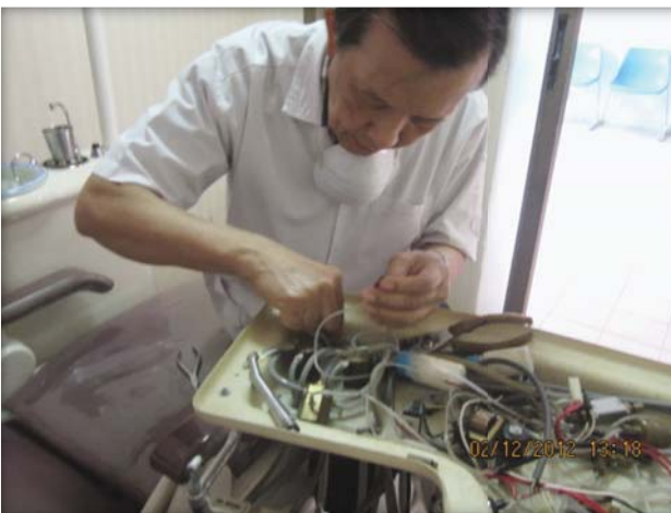
จะเห็นส่วนที่เป็น valve ติดอยู่ในรูเนื่องจาก มีตะกอนเกาะจนไม่ขยับ น้ำจึงผ่านไม่ได้
