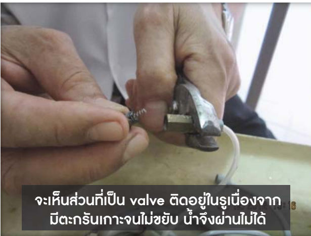
ดึง valve ออกมาทำความสะอาด แล้วใส่กลับเข้าที่
