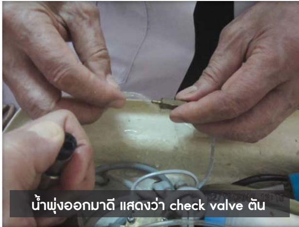
ใช้คีมถอดฝา check valve ออกเพื่อดูข้างใน
