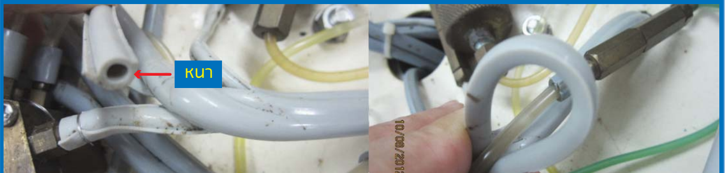
ท่อลมของสายหัวกรอแบบเก่ามีความหนาแน่นมาก งอมากก็ไม่พับ
