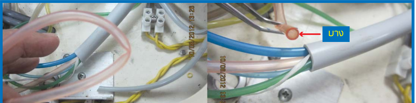
ท่อลมของสายหัวกรอแบบใหม่ท่อเล็กน้อยก็พับแล้ว
